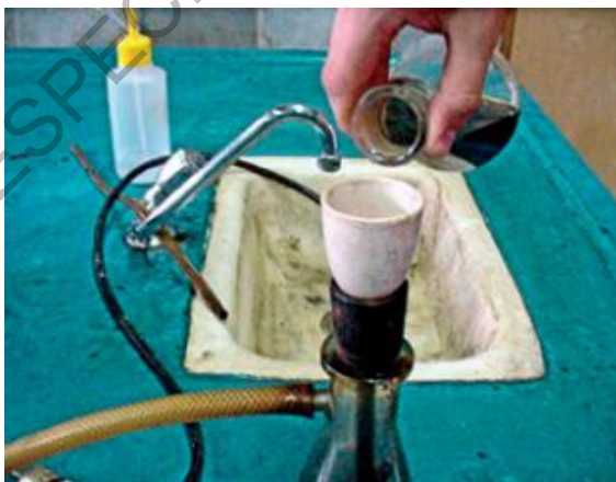
Figura 713 - 4. Filtración de la solución
