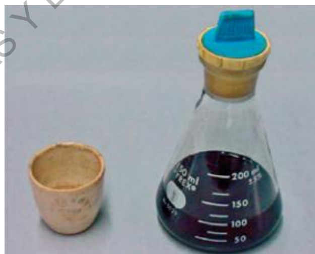
Figura 713 - 3. Muestra disuelta en tricloroetileno
